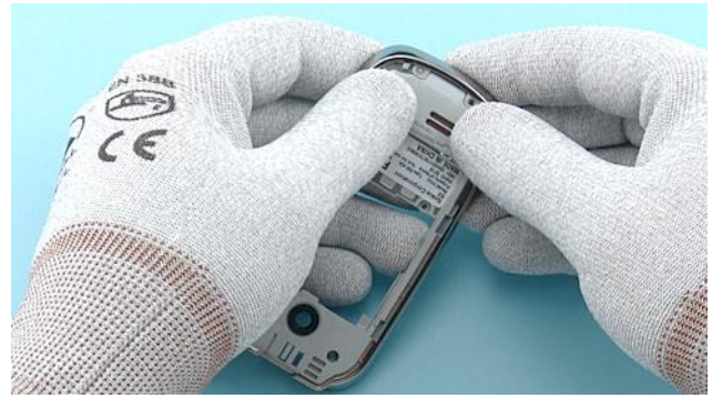
20) Press out the ANTENNA MODULE.
